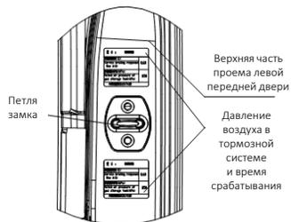
Табличка с указанием давления воздуха и показателями работы тормозной системы (модель с пневматическими тормозами)
