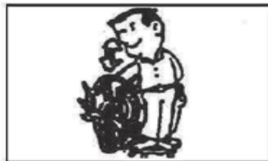
Проверить натяжение ремня вентилятора.
