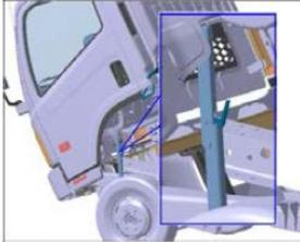
Поднять кабину до предельного положения, проверить блокировку распорки, защелкнуть предохранительную пружину или предохранительный штифт в положении для обеспечения надежной поддержки кабины.
