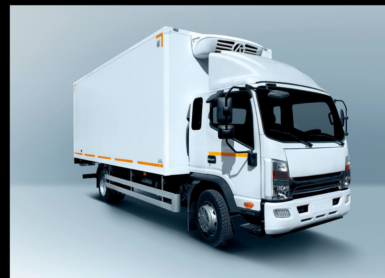
Фургон-рефрижератор из сэндвич-панелей
